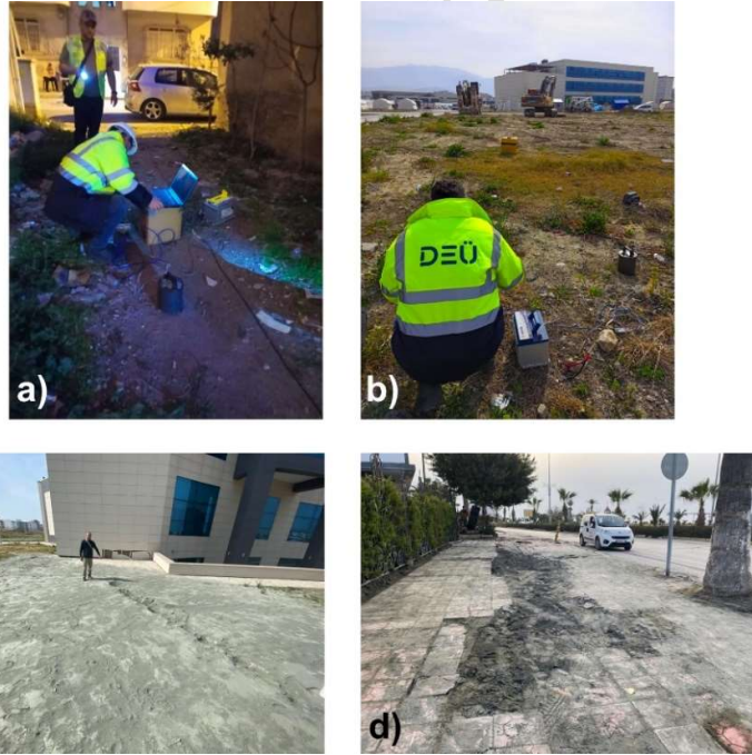
Şekil 2.16. a) ve b) jeofizik ölçümlere ait görseller. c) İskenderun Teknik Üniversitesi kampüsünde ve d) sahil şeridinde karşılaşılan sıvılaşma yapılarına ait görseller.
