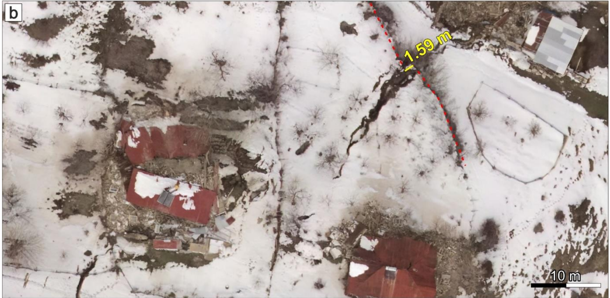
Şekil 4.10 Çardak Fayı'nın oluşturduğu yüzey kırığının Kahramanmaraş ili Göksun ilçesine bağlı Kale mahallesinde yapılan otonom uçuşla modellenmiş (a) sayısal yükseklik modeli ve (b) alandan seçilmiş ortofotolar üzerinden hesaplanmış yatay düzlem üzerindeki sol yanıl ötelenme miktarı.
