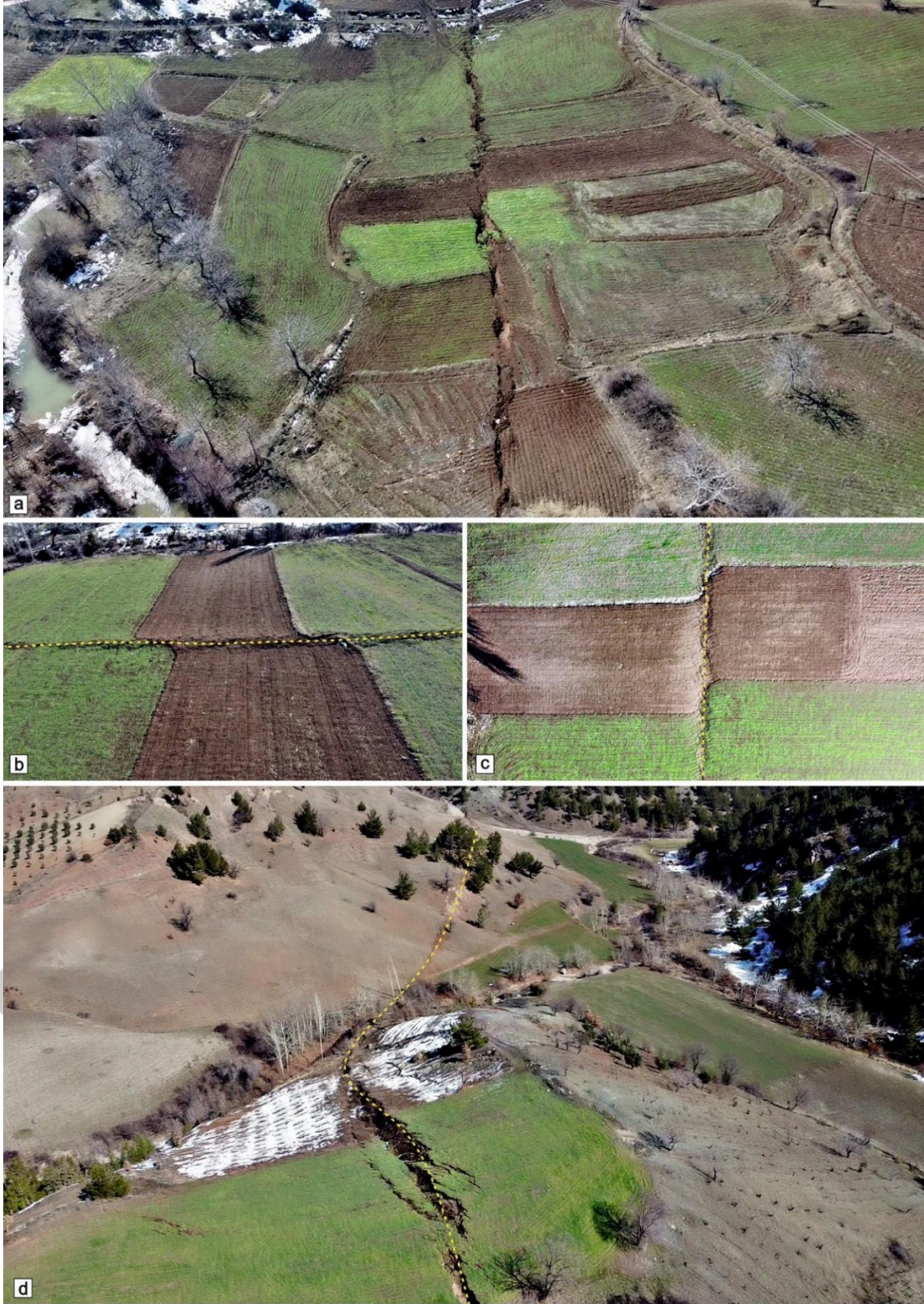
Şekil 3.4 Tırkoğlu – Pazarcık Segmentinde görülen yüzey kırıklarının oluşturduğu yüzey deformasyonlarının İHA görüntüleri. (a) Pazarcık (Kahramanmaraş) yerleşiminin KKD'sundan çekilmiş yüzey kırığı. (b,c) tarla sınırlarında görülen sol yönlü ötelenmeler. (d) Büyüknacar (Kahramanmaraş) yerleşimi sınırları içinde görülen yüzey kırığı ve sismotektonik deformasyonlar. Sarı kesikli çizgiler yüzey kırığını göstermektedir.
