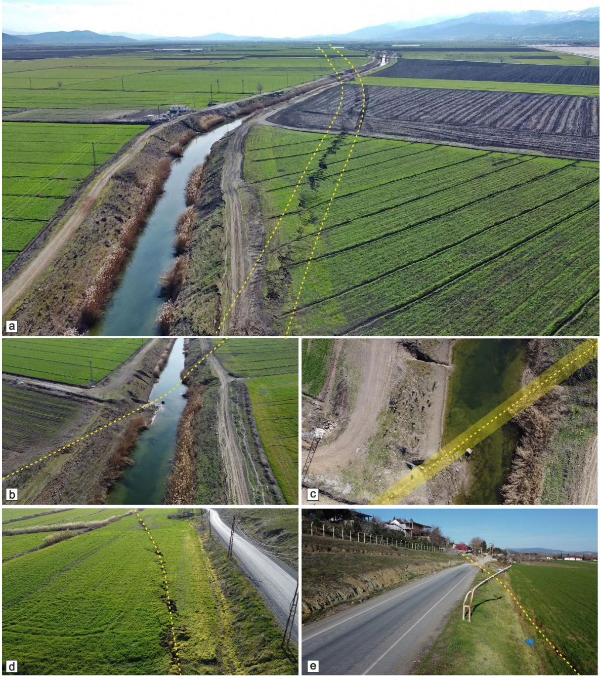
Şekil 3.3 Türkoğlu – Pazarcık Segmentinde görülen yüzey kırıklarının oluşturduğu yüzey deformasyonlarının İHA görüntüleri. (a) Türkoğlu (Kahramanmaraş) yerleşiminin DKD'sinde çekilmiş yüzey kırığı. (b ve c) Türkoğlu (Kahramanmaraş) yerleşimindeki sulama kanalında görülen sol yanal ötelenme. (d) Kuyumcular (Kahramanmaraş) yerleşimindeki tarlalarda görülen yüzey kırığı. (e) Kuyumcular (Kahramanmaraş) yerleşimindeki yüzey kırığının altyapı elemanlarında oluşturduğu deformasyonlar. Sarı kesikli çizgiler yüzey kırığını veya kırığın geçtiği alanı vurgulamak için kullanılmıştır.
