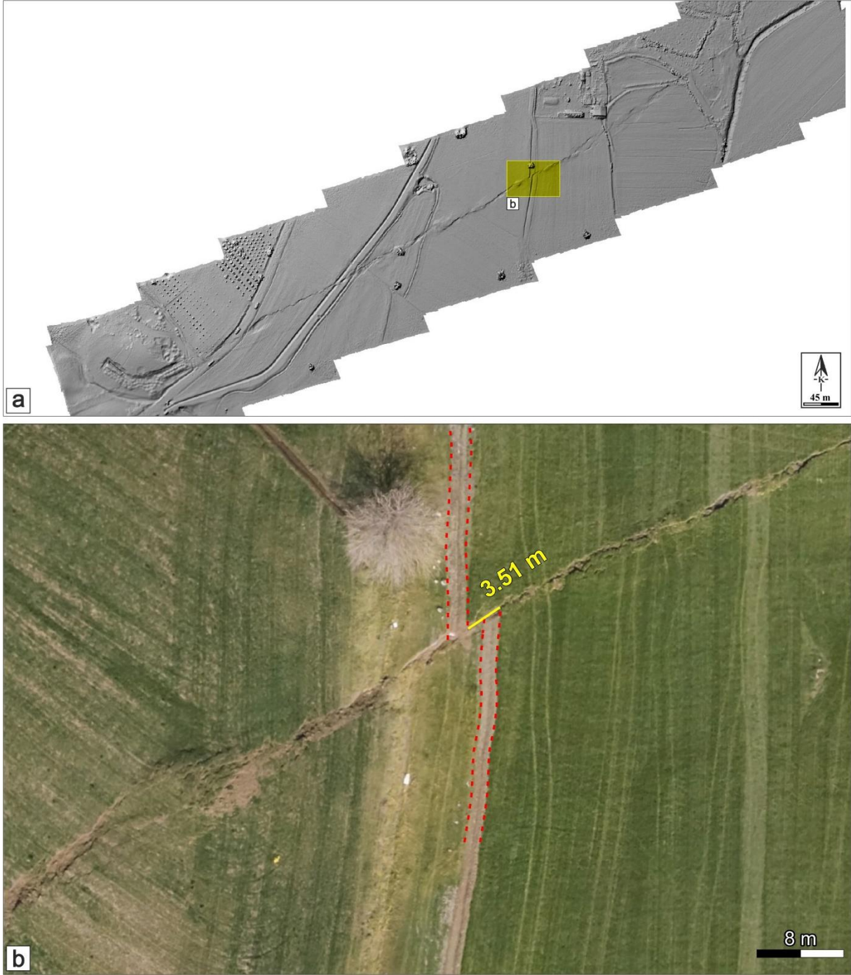
Şekil 4.6 DAFZ'nin Türkoğlu-Pazarcık segmentinin güneybatı ucunda Kahramanmaraş iline bağlı Dulkadiroğlu ilçesine bağlı Tevekkelli mahallesinde gözlenen yüzey kırığından alınan verilerden oluşturulmuş (a) sayısal yükseklik modeli ve (b) alandan seçilmiş ortofoto üzerinden hesaplanmış sol yanıl ötelenme miktarları.
