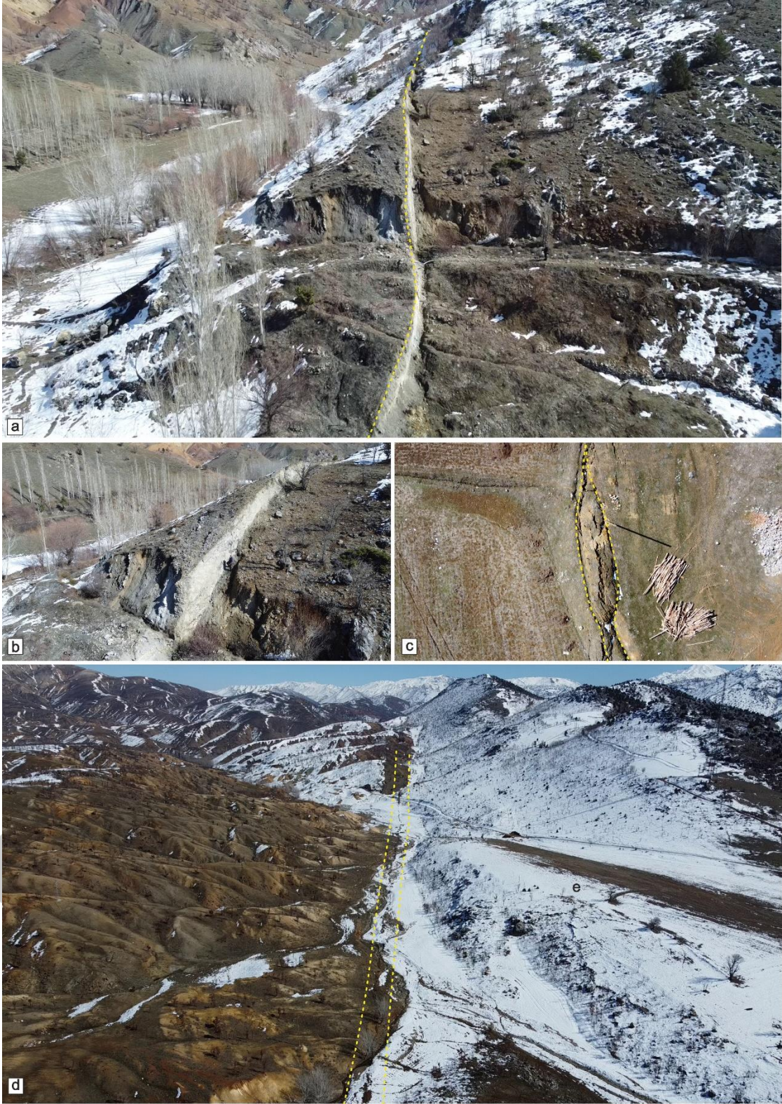
Şekil 3.6 Sürgü Fayı'nın batı bölümlerinde gözlenmiş yüzey kırığının oluşturduğu sismotektonik deformasyon öğelerine ait İHA görüntüleri. (a ve b) Tatlar (Kahramanmaraş) yerleşimde görülen sol yönlü ve düşey bileşenli yüzey kırığı, (c) Kullar (Kahramanmaraş) yerleşiminde görülen yüzey kırıkları arasında sıkışarak yükselen yukarı yükselme (pop-up) yapısı ve (e) yerleşimin kuzeydoğusunda uzanan yüzey kırığının İHA görüntüsü. Sarı kesikli çizgiler yüzey kırığını veya kırığın geçtiği alanı vurgulamak için kullanılmıştır.
