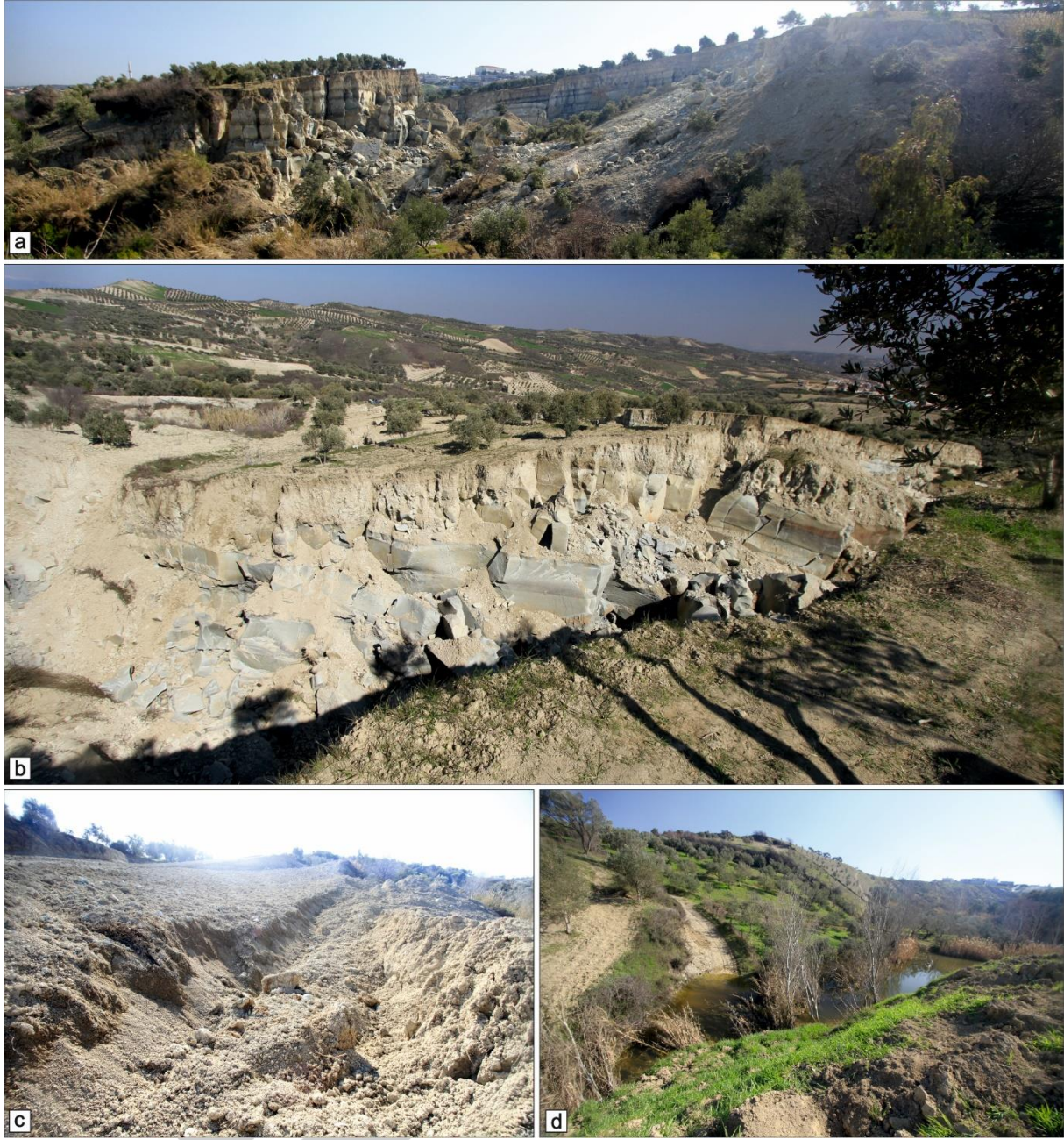
Őekil 2.3 Hatay ili Altınz ilesine bađlı Tepehan kyndeki zeytinlikte meydana gelen ktle hareketi, (a-b) Tepehan formasyonuna ait killi kiretařı, marn, ince kırıntılı ve karbonatlı kellerine ait yzlekler, (c) topuk blmnn st seviyelerini oluřturan kaliř ieriđi yksek toprak rts, (d) yer altı ve yzey sularının oluřturduđu topuk glckleri.
