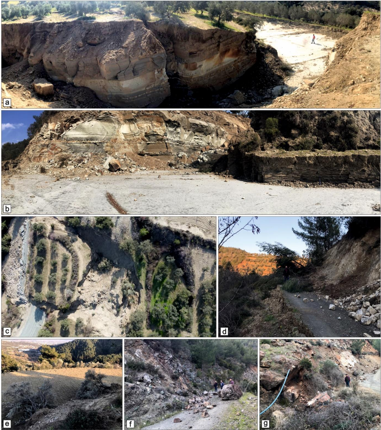
Şekil 2.7 Yayladağı – Samandağ merkezli deprem ile ilişkili kütle hareketlerine ait arazi fotoğrafları. Hatay ili Samandağ ilçesine bağlı Çökek – Toygarlı yolu üzerinde (a-b) kiltası ve kumtaşı katman düzelmlerini kullanarak gerçekleşen kütle kayması, (c) rotasyonel heyelanın insansız hava aracı (İHA) ile çekilmiş ortofotosu. (d ve e) Karaali mahallesinin batısında gözlenen döküntü çığı tipi kütle hareketleri, (f ve g) sırasıyla bazik magmatiklerden kopan bloklar ve eski süreksizlikler boyunca gelişmiş kaya devrilmeleri.
