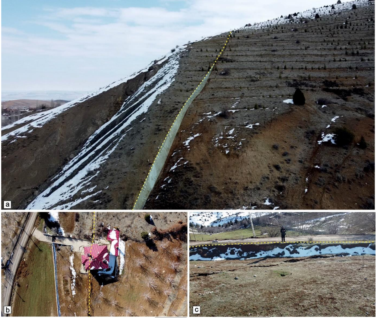
Şekil 3.7 Çardak Fayı'nda üzerinde izlenen yüzey kırıklarının oluşturduğu yüzey deformasyonlarının İHA görüntüleri. (a) Ericek (Kahramanmaraş) yerleşimde görülen sol yönlü düşey bileşenli yüzey kırığı sarplığı. (b) Gözpinar (Kahramanmaraş) yerleşiminde rotasyona uğramış binanın fotoğrafı, (c) yüzey kırığının düşey bileşeni gösteren arazi fotoğrafı. Sarı kesikli çizgiler yüzey kırığını veya kırığın geçtiği alanı vurgulamak için kullanılmıştır. Gölge alan taze yüzey kırığı sarplığının geometrisini belirginleştirmek için oluşturulmuştur.
