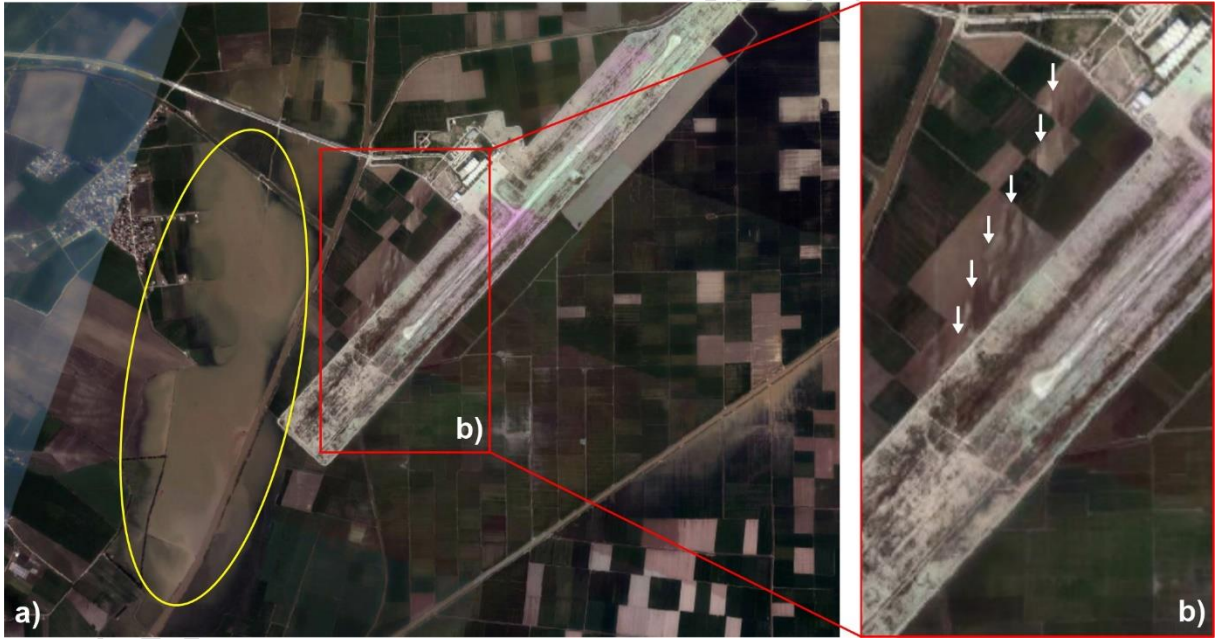
Şekil 23. Hatay Havalimanı çevresindeki zemin sıvılaşması (a) ve yüzey kırığı izleri (b) (HGM Küre, Harita Genel Müdürlüğü). Sarı renkli elips sıvılaşma alanını ve beyaz renkli oklar ise yüzey kırığını göstermektedir.
